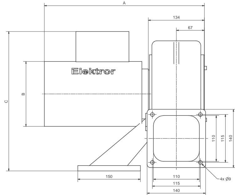
Achtung! Klemmenkasten bei 60Hz-Gerät um 45° gedreh t!
