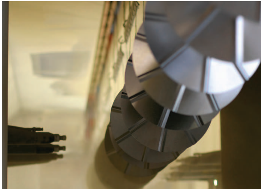
Опоры для конвейерных окрасочных линий обеспечивают колёса, оснащённые подшипниками со смазкой на основе графита.
